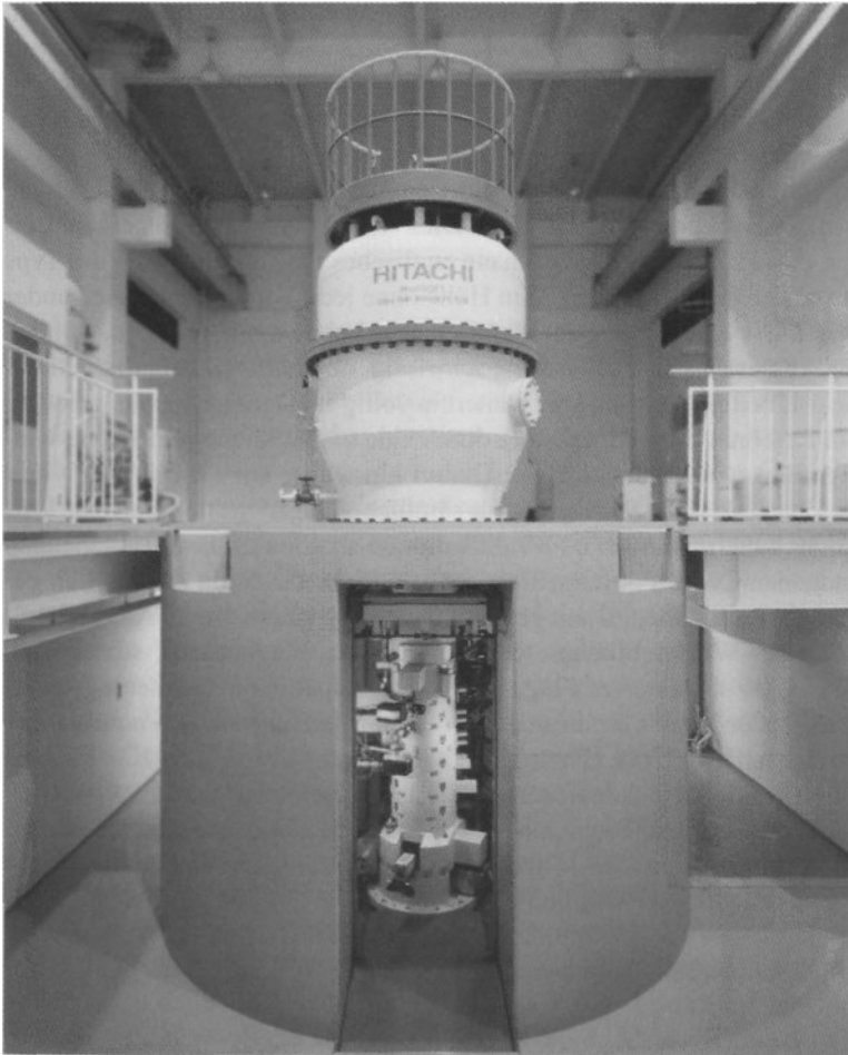
Abbildung 1.1: Modernes Elektronenmikroskop mit einer Beschleunigungsspannung von einer Million Volt (Foto: A. Tonomura)
