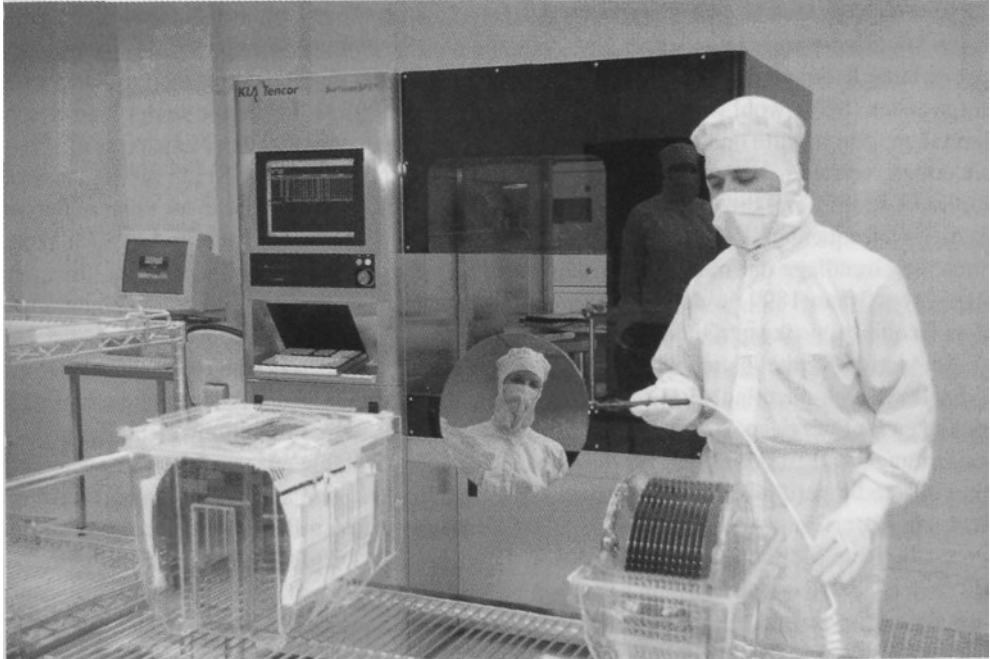
Abbildung 6.1: Verarbeitung der Silizium-Wafer mit 30 cm Durchmesser (Foto: Wacker-Chemie GmbH).
