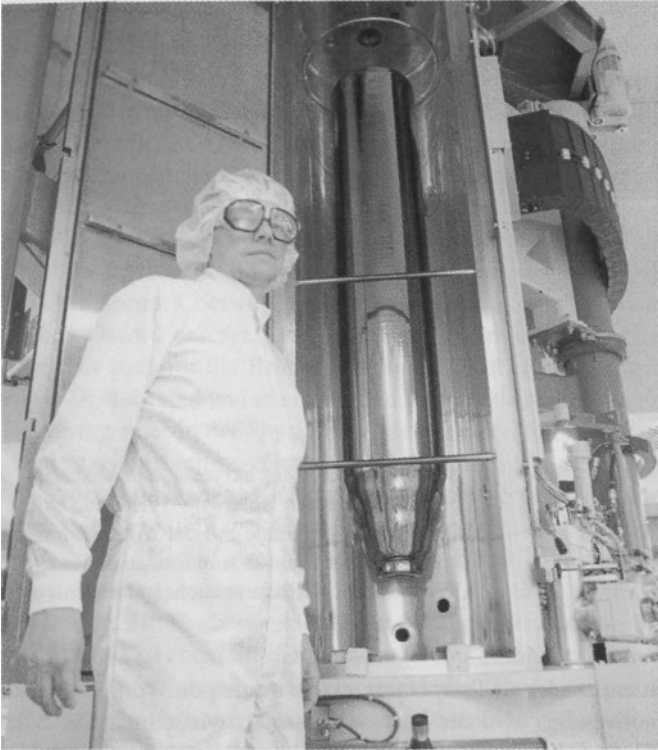
Abbildung 1.6: Silizium-Einkristall (Foto: Fa. Wacker-Chemie GmbH)
