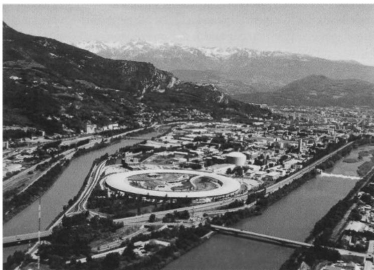
Abbildung 2.8: Luftaufnahme der großen europäischen Synchrotron Strahlenquelle in Grenoble (heller Ring im Vordergrund). Der runde turmartige Behälter neben dem Ring ist die Außenhülle des deutsch-französischen Forschungsreaktors des Laue-Langevin-Instituts (Foto: Studio de la Révirée, Grenoble).
